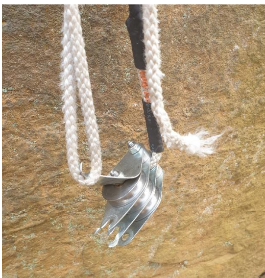
Bei 12 kN zerstörter Flaschenzug nach radialer Belastung. Die Schwachpunkte waren hier die Bleche des Rollenblocks.
