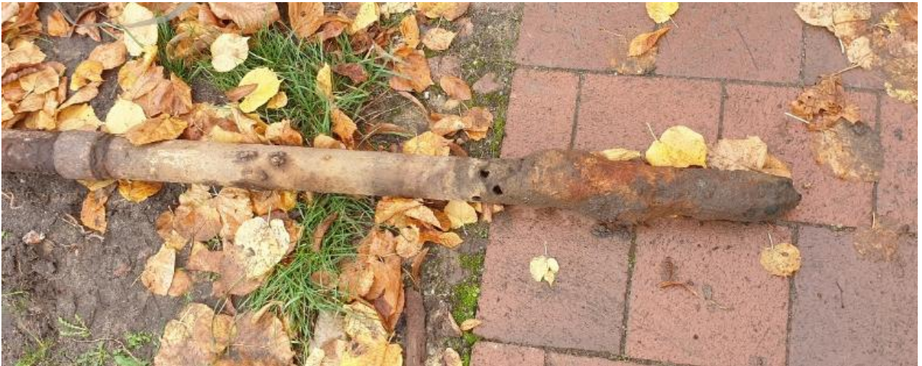
Die bis zuletzt vorhandene Schwengelpumpe scheint aus der Periode der letzten Abdeckung (Betonplatte mit Einstieg) zu stammen. Dazu wurde das unten verschlossene Saugrohr zur Entlastung blind in das Bodensediment gelassen und im Ansaugbereich mit drei Einströmöffnungen versehen (Foto: Ulrike Simmert).
