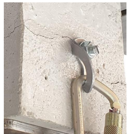
Horizontaler Bruch des Betonwürfels bei ca. 30 kN
