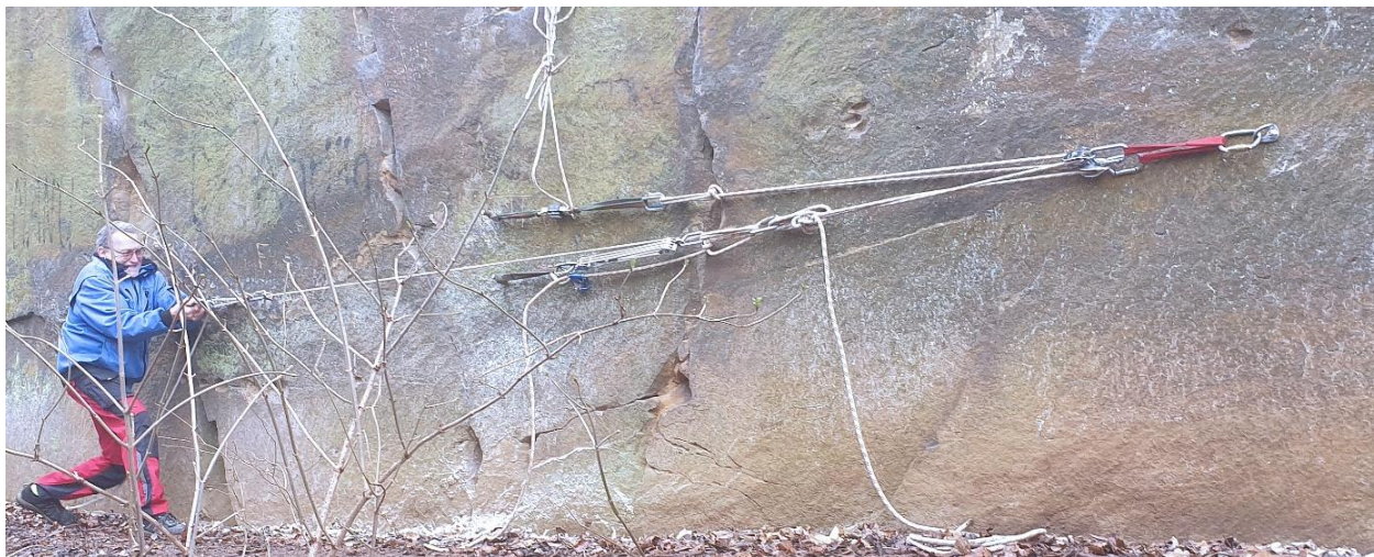
Falk Thieme beim radialen Lasttest unter Verwendung mehrerer gekoppelter Flaschenzüge. Ganz rechts der zu prüfende Anker. Links oben ein Fixpunkt mit der gegen Absturz gesicherten Kraftmessdose. Links unten ein zweiter Fixpunkt, gegen den mit einem verstärkten Flaschenzug 4vs3 Rollen/8mm-Seil gezogen wird. Der Prüfer links zieht über einen weiteren einfachen Flaschenzug.
