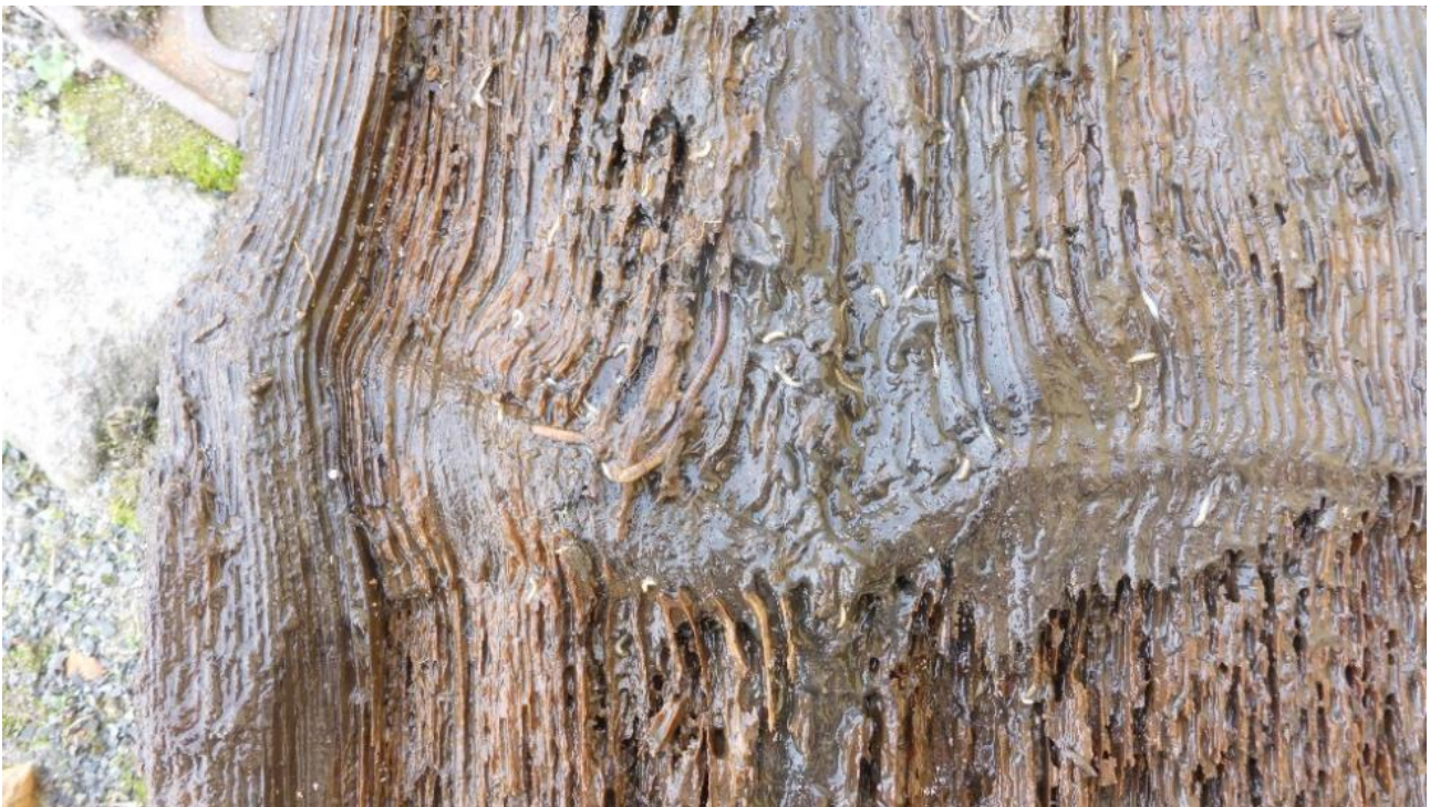
Auf einem geborgenen Holzfragment sind deutlich der Zerfall der Holzsubstanz und die Besiedlung mit Käferlarven zu erkennen (Foto: Alexander Ramm).
