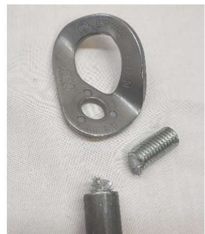
Verformte Winkellasche und gebrochener Gewinde- bolzen
