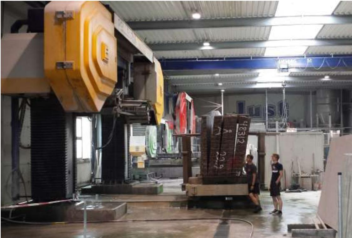
Diese Seilsäge kann mit mehreren diamantbesetzten Seilen gleichzeitig arbeiten und große Natursteinblöcke in gewünschte Plattenstärken teilen. Aus Steinbrüchen weltweit kommen Steinblöcke der verschiedensten mineralischen Zusammensetzung nach Hartha (Sachsen) und werden hier in die gewünschte Form und Qualität gebracht. (Foto: Hartmut Simmert)
