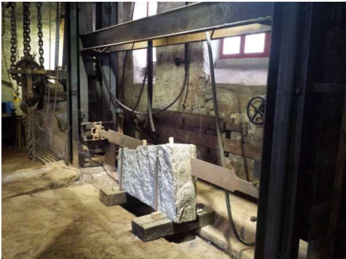
In der „Alten Steinsäge“. Der Granit wird im Prinzip nicht durch das Blatt selbst zerteilt, sondern durch den kleinen Schlackeschrot, der in den Sägespalt gegeben wird. (Foto: Hartmut Simmert)
