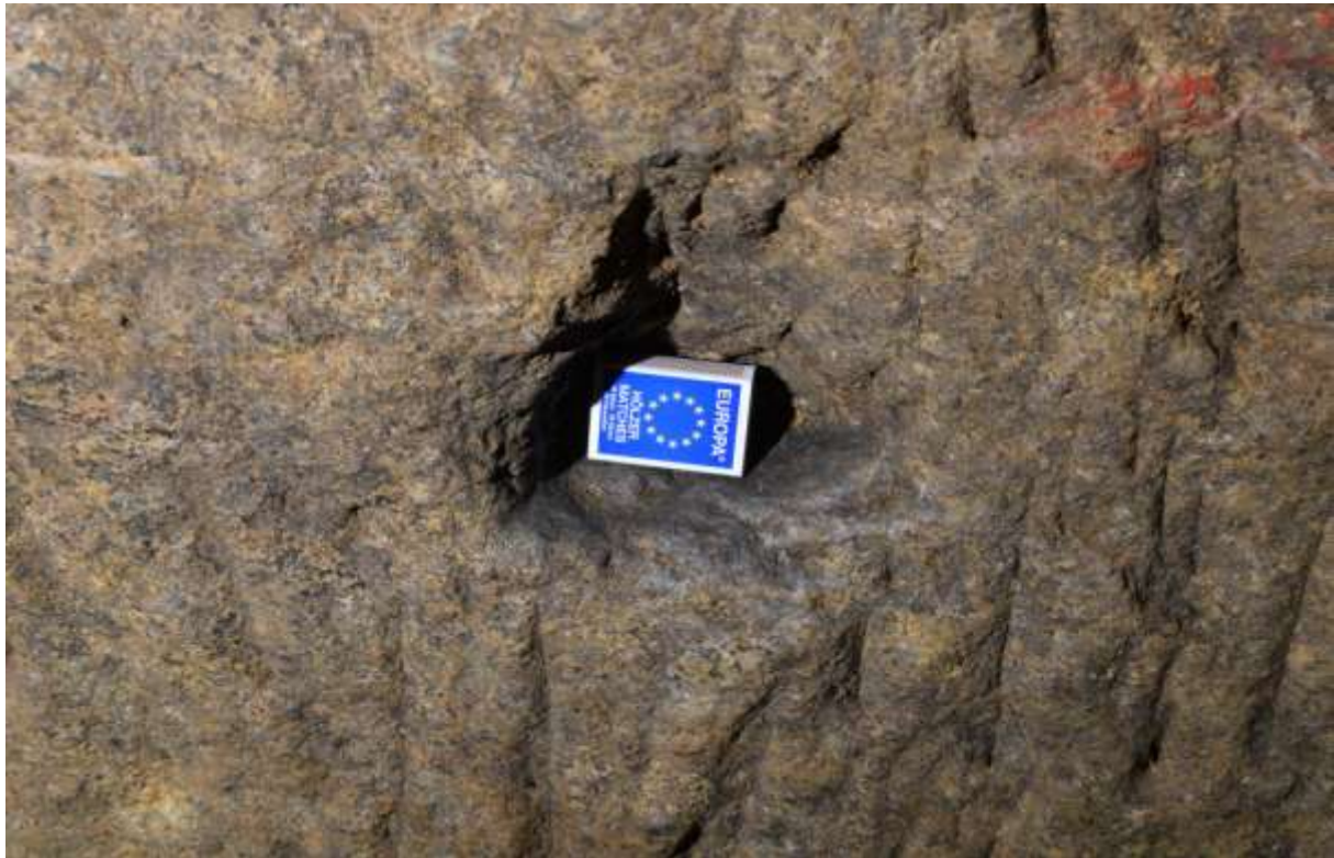
Detail Felswand mit Schrammspuren vom Bergeisen und „Geleuchtnische“ (Foto: Alvaro Aguilera)
